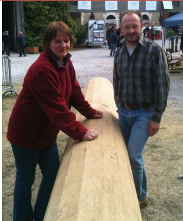
Le nouvel axe exposé au salon du bois à Launois. 5 m de long, 50 cm de diamètre, hexadécagonale pour environ 800 kilos;
